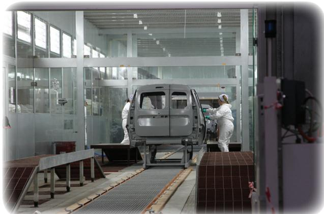
Тщательность обработки кузова сразу бросается в глаза. Между стадиями окрасочной технологии кузова производится контроль качества, в случае необходимости – доводка (шлифовка, полировка).
