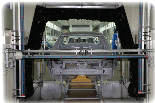
Окрасочный цех требует чистой атмосферы, поэтому перед входом в окрасочную камеру одежда маляров обдувается воздухом. Также сжатым воздухом периодически обдуваются кузова, а на одной из финальных стадий грунтования кузовов проходит обработку (удаление микрочастиц) специальными щетками, сделанных из перьев страуса эму. Участок этот так и называют – «эму». (P.S. При строительстве окрасочного комплекса ни одного страуса не пострадало).
